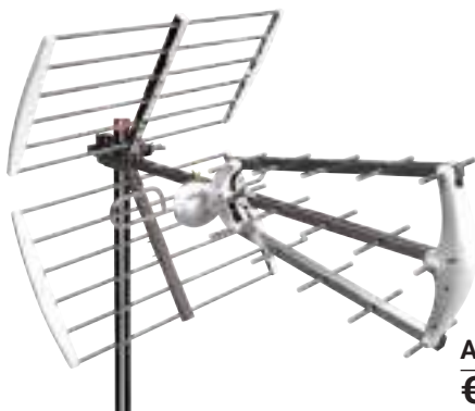
Antenna ZTL-236B5G Antenna tripla DDT, Banda UHF, 29 elementi, Canali 21- 48, Frequenza 470-694 Mhz Guadagno 10 - 15 dB
