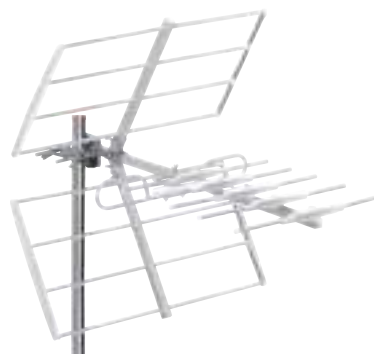
Antenna ZTL-368C5G Antenna DDT, Banda UHF, 8 elementi, Canali 21- 48, Frequenza 470-694 Mhz Guadagno 9 - 13 dB
