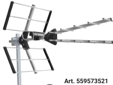
Antenna IR-D12-5G Antenna DDT 5G ready Banda UHF, 12 elementi Canali 21- 48 Frequenza 470 - 694 Mhz Guadagno 9,5 - 13,5 dB
