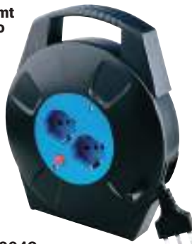
Avvolgicavo 25 mt 4 prese bipasso 10/16A spina 16A con protezione termica ripristinabile
