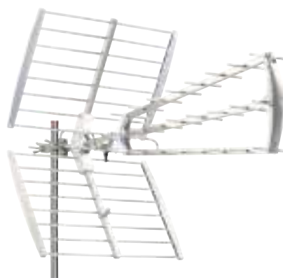
Antenna ZTL-118F5G Antenna tripla DDT, Banda UHF, 23 elementi ad X, Canali 21- 48, Frequenza 470-694 Mhz Guadagno 12 - 14 dB
