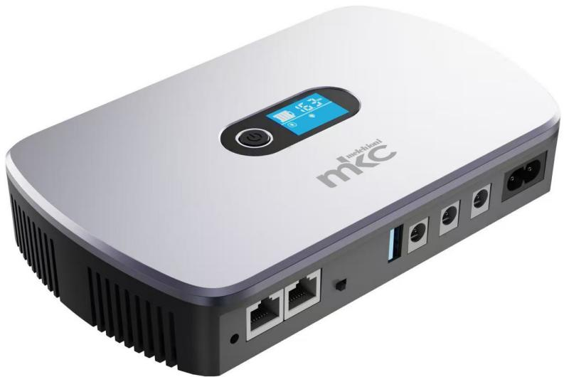
Il Mini UPS MK-8800 è un gruppo di continuità compatto e versatile, progettato per garantire alimentazione stabile a dispositivi a bassa tensione come router, modem, telecamere IP e sistemi domotici. Dotato di display LCD per un monitoraggio intuitivo dello stato di carica e funzionamento, offre uscite DC 5V/2A, 9V/1A, 12V/1A e POE 24V/0.6A.
