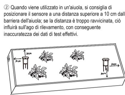
(2) Quando viene utilizzato in un'aula, si consiglia di posizionare il sensore a una distanza superiore a 10 cm dalla barriera dell'aula; se la distanza è troppo ravvicinata, ciò influirà sull'ago di rilevamento, con conseguente inaccuracy dei dati di test effettivi.
