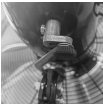
Bullone nel foro di destra: funzione swing attivata (gabbia oscillante)
