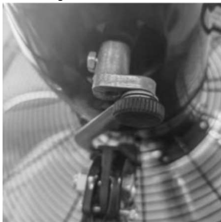
Cerrojo en el agujero derecho: función de swing activada (jaula de swing)
