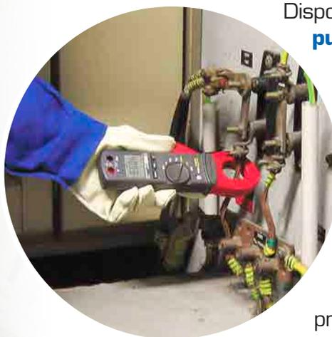
Dispone di un **display di 10000 punti retroilluminato**, congelamento della visualizzazione, funzioni **di misura del valore max e differenziale** (Delta).
