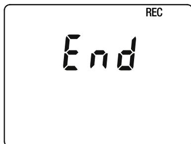
Se lo strumento visualizza il presente schermo in fase di avvio, ciò significa che una sessione di registrazione è stata brutalmente interrotta dallo spegnimento dello strumento in seguito a un'interruzione di corrente.
