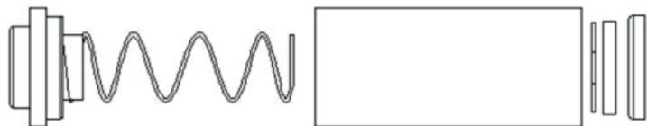
Sequenza di assemblaggio del canale di accumulo: rimuovere il materiale dal tubo in vetro e ricomporre il gruppo di filtraggio come indicato in figura.
