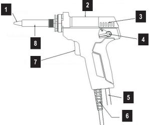
Ugello Trasferisce il calore sull'area da dissaldare – Foro di entrata per la lega liquefatta
