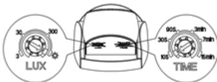
*Nota: durante il test alla luce del giorno, ruotare la manopola LUX ☀ in posizione SUN (Sole), altrimenti la luce del sensore potrebbe non funzionare!*
