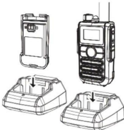
siano correttamente inseriti nel caricabatterie: a tal fine è necessario verificare che l' indicazione luminosa sia di colore rosso
