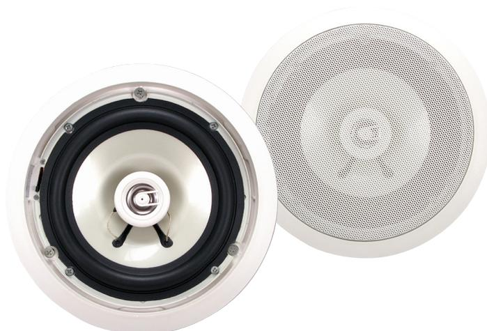
Il design semplice ed elegante, in un robusto cabinet, la griglia protettiva li rendono adatti a qualsiasi ambiente ed esigenza di sonorizzazione. È presente sul fronte dei diffusori un selettore per il settaggio dell'impedenza (80hm o 100V) e il Vantaggio in uscita. Nella modalità 80hm, per uso HiFi la potenza in uscita è di 80W (35W RMS), in modalità 100V è possibile selezionare una potenza di uscita da 1-2-4-8-15W.
