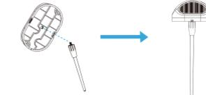
② Una volta completato il montaggio, inserire l'unità in un'area esterna aperta. Assicurarsi che il dispositivo sia stabile e posizionato in verticale senza inclinazioni.
